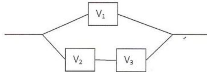
Le circuit est en état de marche si  $V_1$  est en état de marche ou si  $V_2$  et  $V_3$  le sont simultanément.
